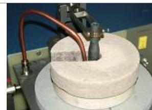
La machine ne doit pas être utilisée si le creuset n'est pas correctement installé dans la chambre. Toutes les opérations citées ci-dessus doivent être menées lorsque la machine n'est pas alimentée.
