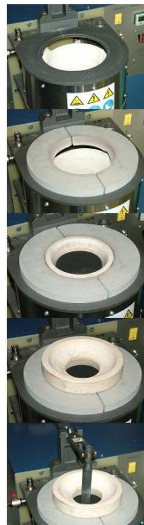
Si nécessaire, le sabot doit être couvert et un tube en cuivre doit être connecté à la ventilation du gaz de protection.
